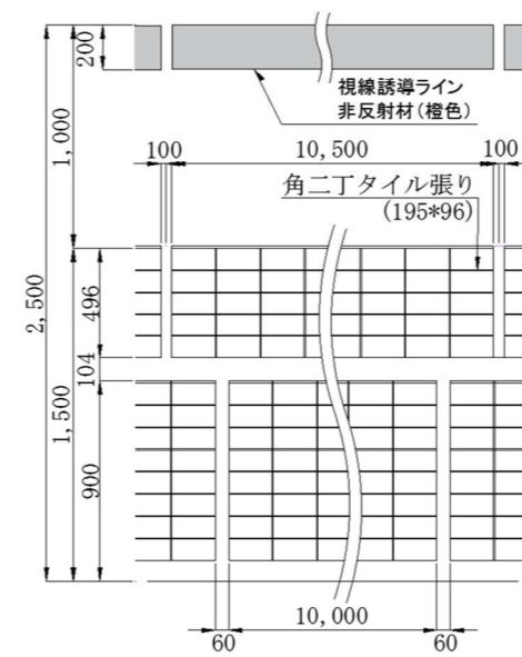
図7.7 内装高さ1.5mと視線誘導ライン 非反射材(橙色) (監視員通路有)
